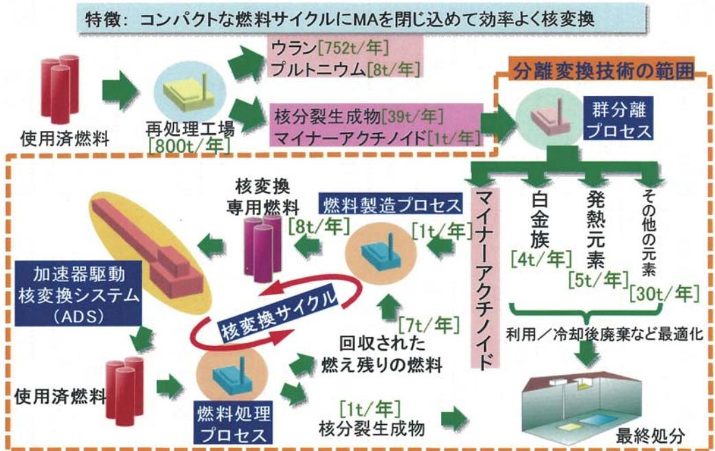
図3 階層型分離変換技術のマスフロー
