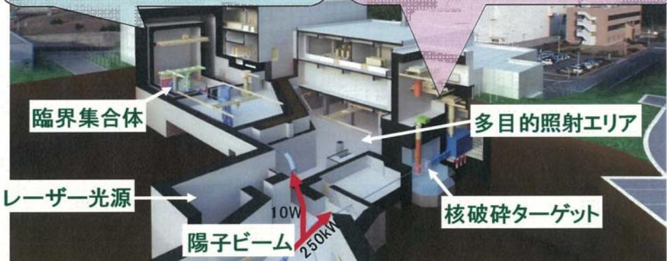
図4 核変換実験施設
