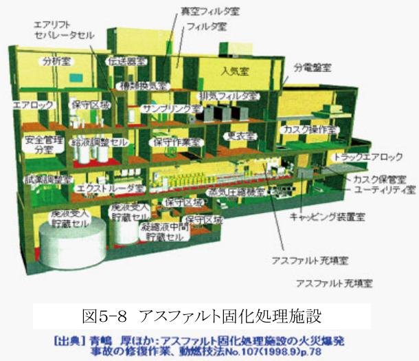
図5-8 アスファルト固化処理施設
