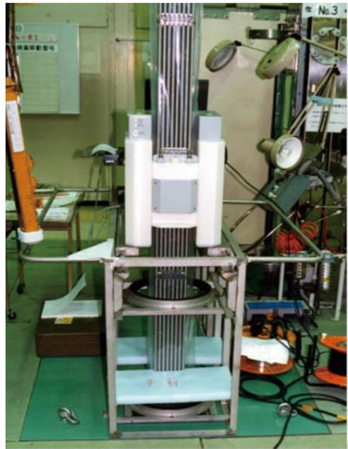
写真 3-1-4 ウラン量測定 (UNCL) <sup>3.1-1)</sup>
