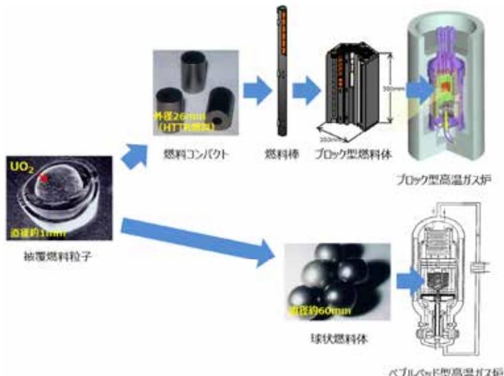
図5.1-3 ブロック型高温ガス炉とペブルベッド型高温ガス炉
