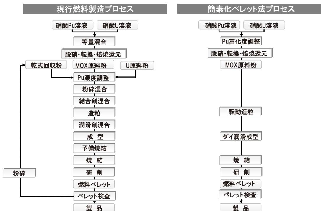
図4.2.6-1 MOX燃料製造のプロセスフロー図（現行工程及び簡素化ペレット法）
