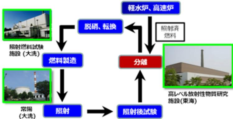
図4.2.6-3 小規模 MA 分離変換実証研究の工程フロー
